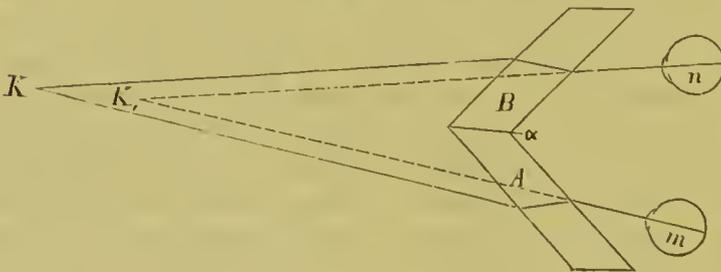
schätzen. In einem Gestelle befinden sich zwei dicke planparallele Prismen A und B aus Glas. Diese sind so gegeneinandergestellt, dass sie mit einander einen rechten Winkel einschliessen. Wenn nun dem
